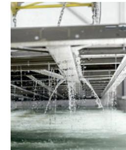
Die Größe unserer KTL-Station ermöglicht das vollständige Eintauchen des Rahmens im kataphoretischen Lackierprozess.
